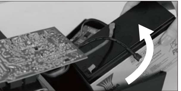
10. Замените батарею и подсоедините провода к соответствующим контактам следующим образом: красный провод подключается к красной положительной клемме, а черный провод подключается к черной отрицательной клемме.
