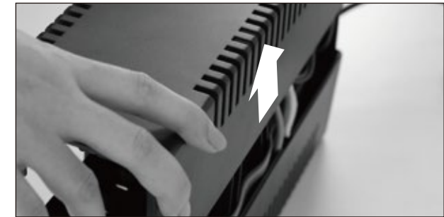
5. Верните ИБП в нормальное положение и откройте крышку.
